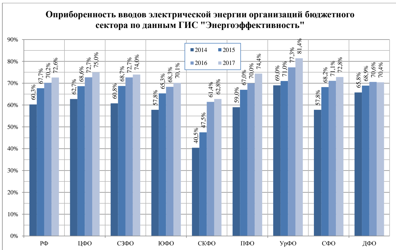
Рис. 5. Оприборенность вводов электрической энергии организаций бюджетного сектора по данным ГИС «Энергоэффективность», %
